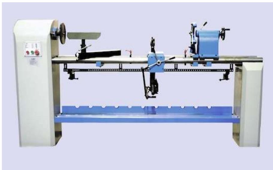
Токарные станки по дереву предназначены для обработки тел вращения путём снятия с них стружки при точении. Станок оснащён копиром.
