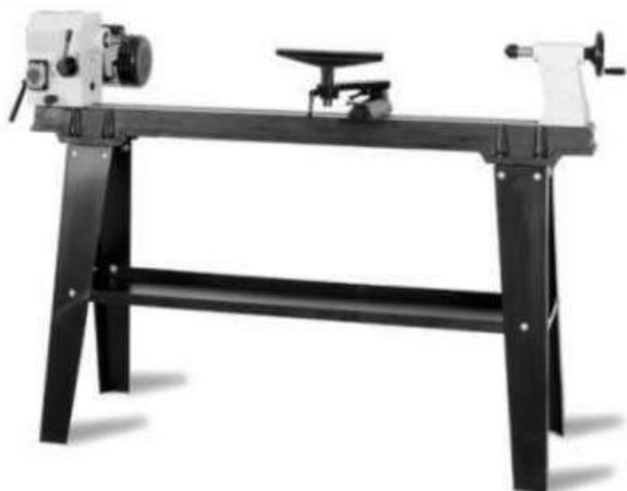
Токарные станки по дереву предназначены для обработки тел вращения путём снятия с них стружки при точении.
