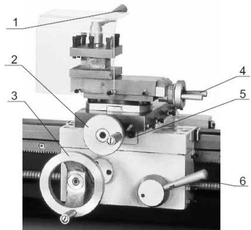
**5. Рукоятка включения и выключения гайки ходового винта 6:** Поворот вниз – включение гайки. Поворот вверх – выключение гайки.
