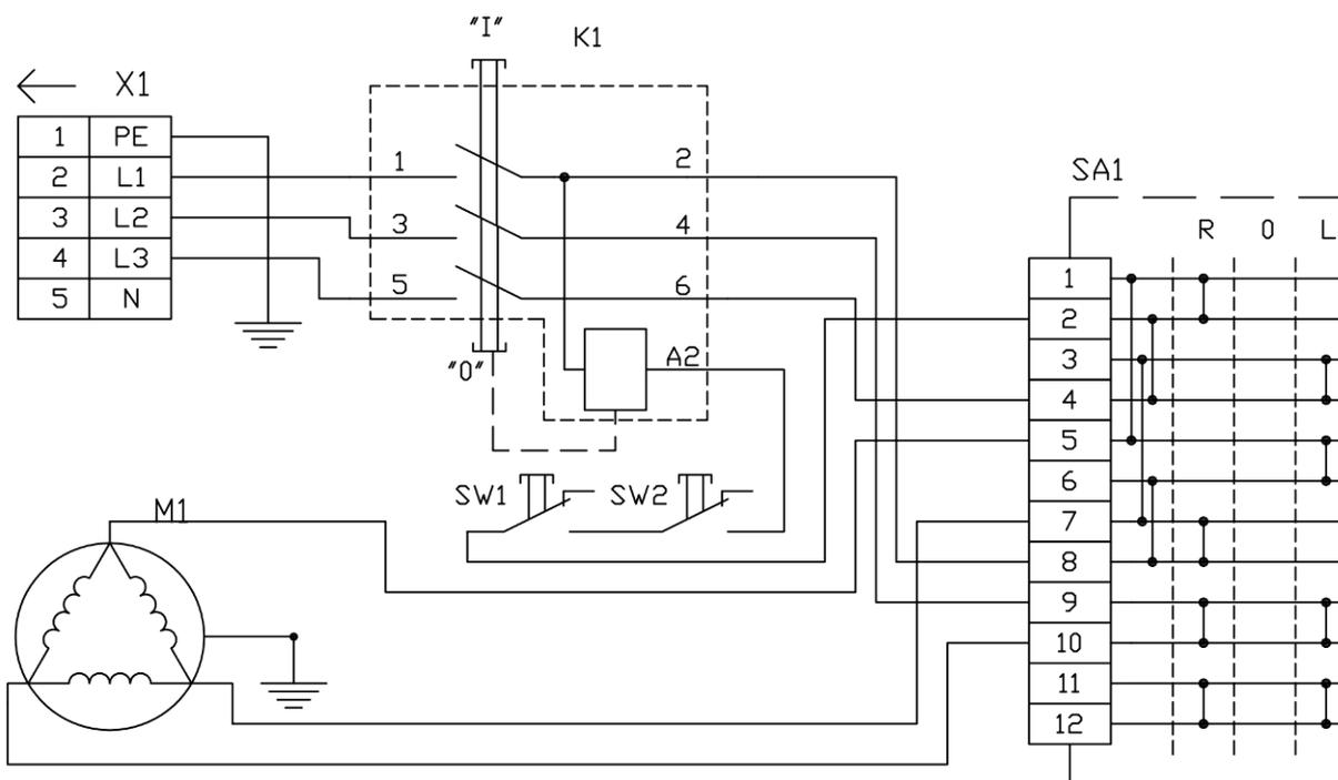
SW1 - Концевой выключатель защитного стекла
