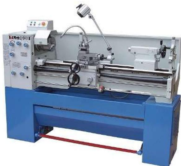
Токарный станок, станок для обработки преимущественно тел вращения путём снятия с них стружки при точении. На токарных станках можно выполнять различные виды токарной обработки: обтачивание цилиндрических, конических, фасонных поверхностей, подрезку торцов, отрезку, растачивание, а также сверление и развёртывание отверстий, нарезание резьбы и накатку рифлений, притирку и т.п.
