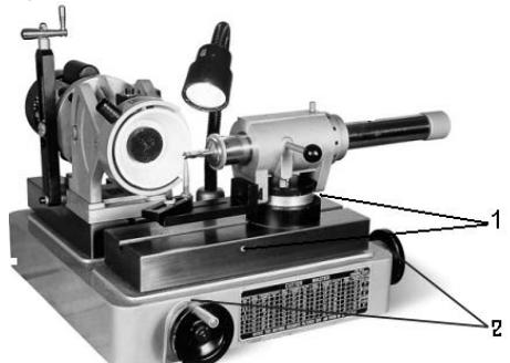
Смазку производите всегда до начала работы или после каждого четырех часов эксплуатации.
