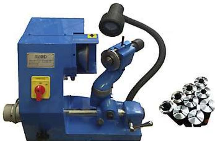
Заточные станки служат для абразивного затачивания металлорежущего инструмента. Инструмент для абразивного затачивания — шлифовальный круг. Станки имеют подвижный суппорт, в котором закрепляется затачиваемый инструмент, для установки под требуемым углом суппорт снабжен шкалой. В комплекте со станком идет набор цанг от 3 до 18 мм.
